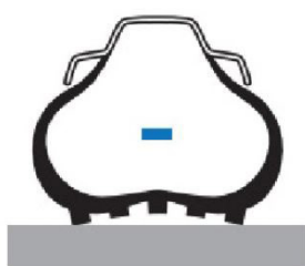
Presión de aire demasiado baja
